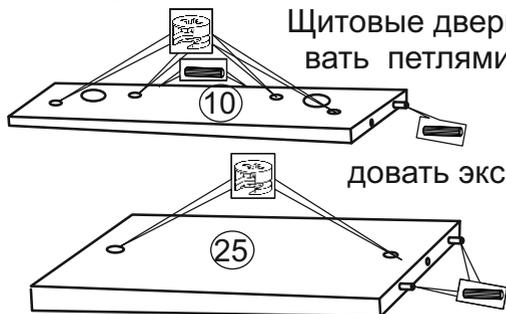
Стенки жесткости 10 и 25 оборудовать эксцентриками на 16 и шкантами 8x30.
