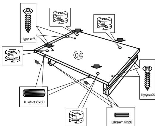
Стенки горизонтальную верхнюю 06 оборудовать эксцентриками, соединительными винтами и шкантами.
