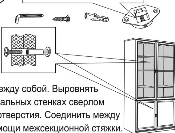
При желании можно соединить между собой две витрины. Для этого необходимо сдвинуть их между собой. Выровнять их по передней кромке. В вертикальных стенках сверлом Ø8 мм насквозь просверлить 2 отверстия. Соединить между собой два изделия при помощи межсекционной стяжки.
