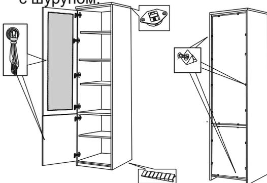
На двери установить ручки. Отрегулировать двери, при необходимости установить под ножки пластиковые подставки.
