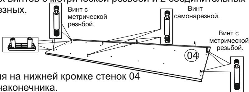
В отверстия на нижней кромке стенок 04 установить 2 наконечника.
